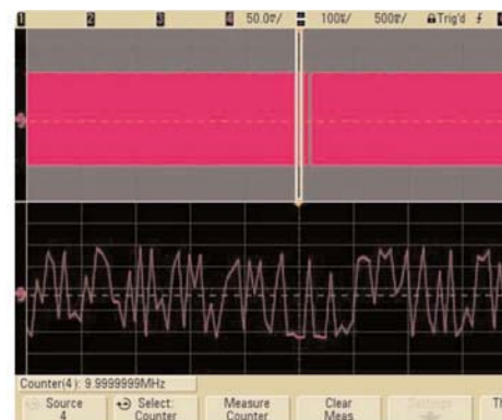
Рисунок 13 - Встроенный аппаратно реализованный частотомер позволяет выполнять измерения частоты с разрешением 8 разрядов при использовании внешнего опорного сигнала с частотой 10 МГц
