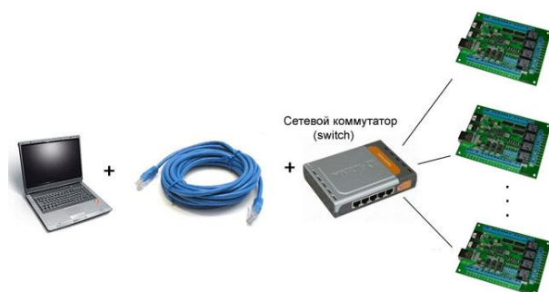
Рис. Схема подключения нескольких модулей к одной сети с использованием роутера
