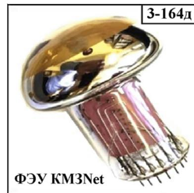
Рис.3.2.1.30д1. Внешний вид ФЭУ КМ3Net.
