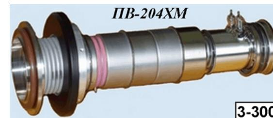
Рис. 3.6.32. Внешний вид рентгеновского преобразователя ПВ-204ХМ.
