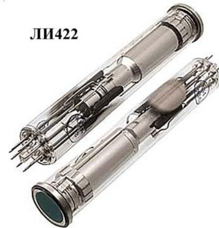
Рис. 3.3.1Б. Внешний вид, геометрические размеры, назначение выводов и относительная спектральная характеристика видиконов.
