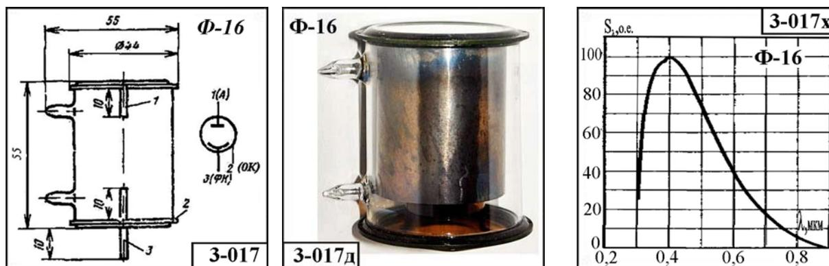
Рис. 3.1.4. Внешний вид, габаритные размеры и относительная спектральная характеристика фотоэлементов серии Ф-XX
