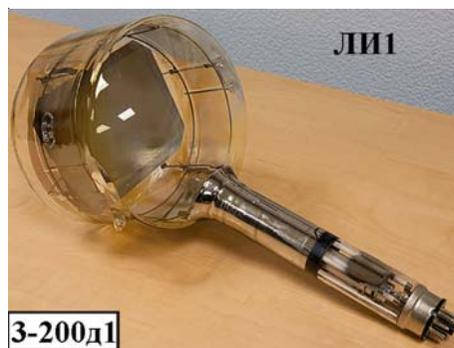
**Примечание.** Чувствительность иконоскопа характеризуется минимальной освещенностью на мозаике, при которой сигнал от черно-белой границы (таблицы 0249) не менее  $0,04 \text{ i } \delta \text{a}$  при четкости изображения в 625 строк.
