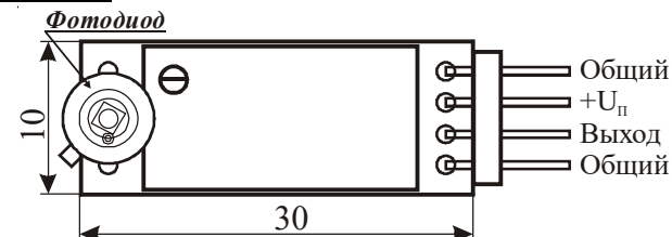
Рис. 1.61д. Внешний вид и габаритные размеры модуля счетчика фотонов на основе микропиксельных фотодиодов.
