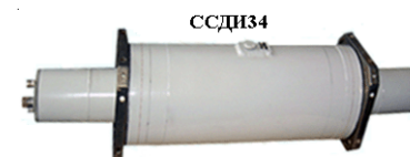
Рис.1.31д Внешний вид детектора ССДИЗ4
