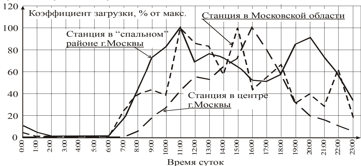
Рис. 27.11. График суточной загрузки БС
