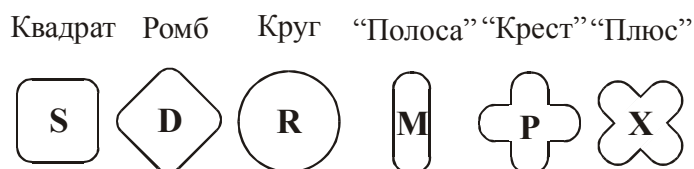
Рис. 21.9. Варианты топологии направляющих плат джойстиков серии HFX, выпускаемых фирмой Rewatron
