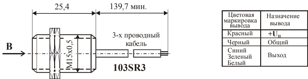
Рис. 14.28. Внешний вид и таблица назначения выводов датчиков серии 103SR
