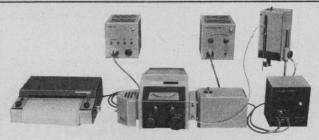
MODEL 139 SPECTROPHOTOMETER CONNECTED TO AUTOMATIC SAMPLE CHANGER AND RECORDER
