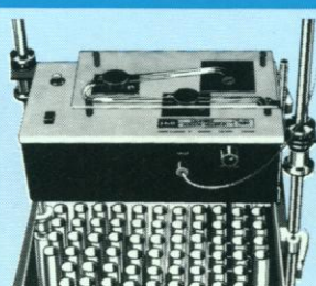
VoluFrac precision volumeter
