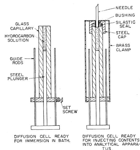
Fig. 1. Diagram of diffusion cell.
