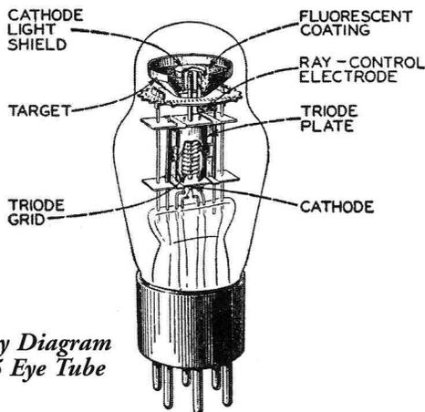
*Cut-Away Diagram of a 6E5 Eye Tube*
