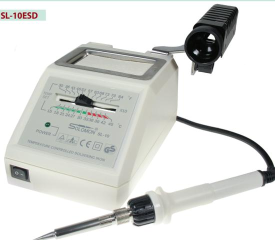
Предназначены для пайки при поддержании постоянной температуры жала паяльника в пределах от 150 до 420°C с точностью 2–3°C. Точность обеспечивается температурным датчиком, расположенным в корпусе нихромового проволочного нагревательного элемента рядом с жалом паяльника, и электронно-цифровой системой регулирования температуры основного блока.
