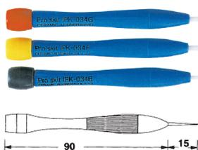
Отвертки имеют электроизолированные антистатические ручки и обладают антимагнитными и диэлектрическими свойствами, изготовлены из высококачественной керамики, устойчивой к кислотам.
