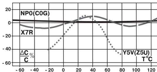
**NPO(COG)** – используется в прецизионных цепях, в рабочем диапазоне емкость практически не зависит от температуры, времени, напряжения и частоты. **ТКЕ = 0 ± 30·10<sup>-6</sup>/°C**.
