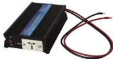
Инверторы предназначены для питания сетевых электроприборов (компьютеров, телевизоров, ламп, приемников, зарядных устройств и т.д.) переменным напряжением 220 В от бортовой сети автомобиля. Приборы имеют защиту от короткого замыкания, перегрева и перемены полярности батарей. При падении напряжения питания ниже определенного уровня (10.5 В для 12 В инвертора и 20 В для 24 В инвертора) устройство автоматически выключается.
