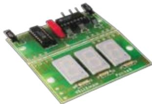
Высокорецизионный измерительный прибор в компактном исполнении. Отличная замена магнитоэлектрическим измерительным приборам с подвижной катушкой. Плата может быть встроена в корпус любого типа, даже в уже существующее оборудование.
