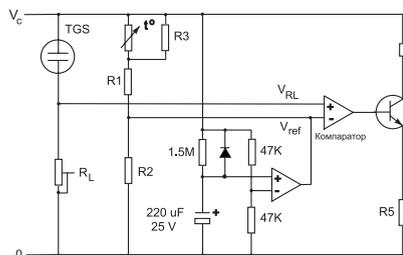
На рисунке показана типичная схема подключения датчика серий TGS8xx и TGS2xxx. В этой мостовой схеме при повышении концентрации газа сопротивление датчика уменьшается, а напряжение на резисторе RL увеличивается. При определенном напряжении компаратор срабатывает, и включается сигнал оповещения. Благодаря включению термистора, работа датчика не зависит от температуры окружающей среды. Изменением сопротивления резистора RL схему можно настроить на требуемую концентрацию газа.
