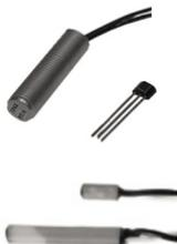
Датчики температуры выпускаются двух типов: с чувствительным элементом на основе п/п структуры и чувствительным элементом в виде терморезистора на двуокисе платины. Корпус выполнен пластмассовым для датчиков на газ или из коррозионно стойкого металла для агрессивных сред. У датчиков на агрессивные среды выводы выполнены по двухпроводной схеме с залитыми герметиком проводами.
