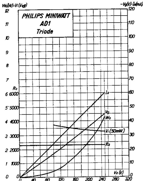
Puissance de sortie  $W_o$  pour une distorsion de 5%.
