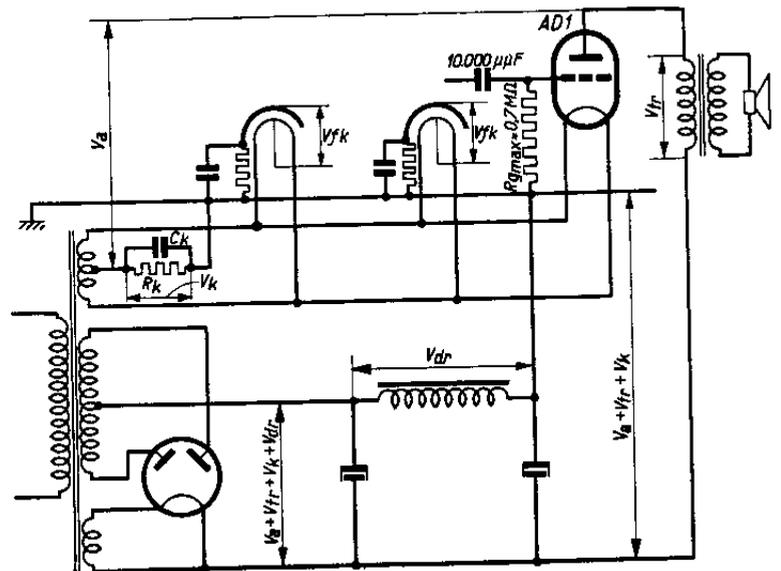
Montage d'une résistance entre le milieu de l'enroulement de chauffage du transformateur d'alimentation et la terre. Cette résistance, shuntée par un condensateur de grandeur suffisante pour permettre la reproduction des notes graves, fournit une polarisation automatique de la grille du tube final à chauffage direct. La tension continue aux bornes du premier condensateur du filtre devra être égale à  $V_a + V_{tr} + V_k + V_{dr}$ .
