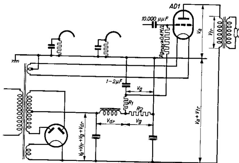
de la résistance serait appliquée directement, à la grille du tube de sortie. En utilisant un condensateur d'une capacité qui ne soit pas trop petite, 1 à 2  $\mu\text{F}$  par exemple, la résistance du filtre ne doit pas être grande, quelques dizaines de mille ohms par exemple. La valeur de la résistance de fuite ne s'en trouve pas notablement augmentée, ce qui permet d'adopter la valeur maximum admissible pour cette résistance (polarisation fixe) ( $R_{gfmax} = 0,3$  mégohm).
