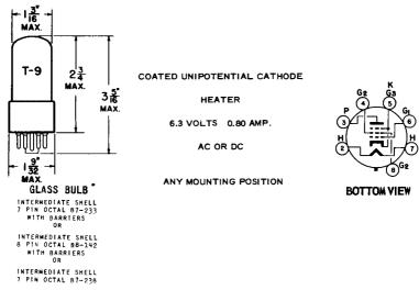
THE 7591 IS A BEAM POWER PENTODE DESIGNED FOR USE AS AN AUDIO FREQUENCY POWER OUTPUT TUBE. IT HAS HIGH POWER SENSITIVITY AND HIGH EFFICIENCY AND IS ESPECIALLY DESIGNED FOR APPLICATIONS WHERE HIGH POWER OUTPUT IS REQUIRED.
