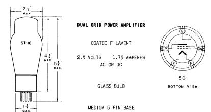
THE TUNG-SOL 46 IS A DUAL GRID POWER TUBE DESIGNED FOR USE IN A CLASS A OR CLASS B OUTPUT STAGE.
