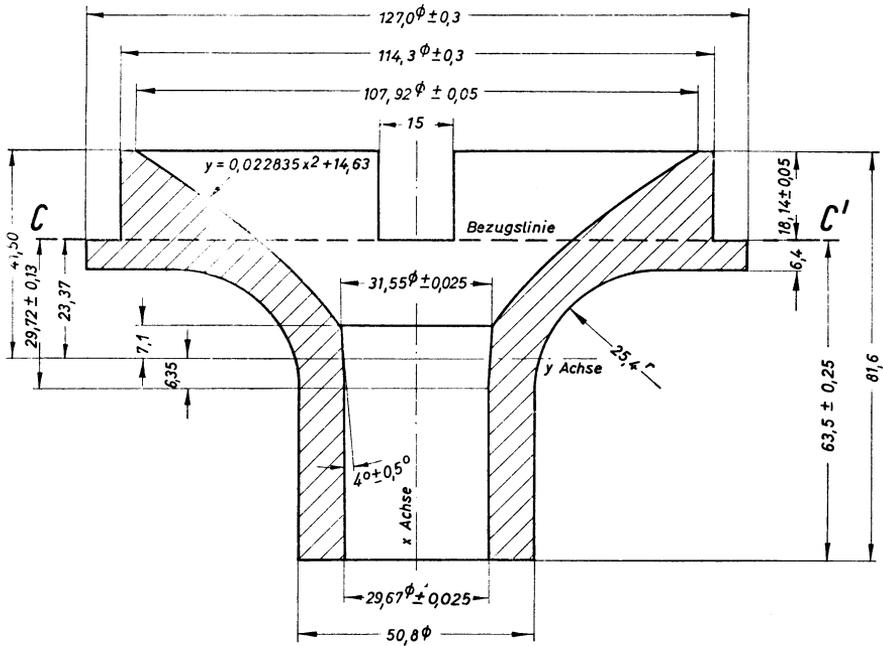
Die Bezugslinienlehre, die zur Bestimmung der Bezugslinie C-C' verwendet wird, gibt außerdem am Bildröhrenhals und Konusübergang die innere Mantelfläche der Ablenkspule an. Da die Konusform oberhalb der Bezugslinie verschieden sein kann, empfiehlt es sich, die Spule nicht mehr als  $18,14 \pm 0,05$  mm über die Bezugslinie hinausragen zu lassen.
