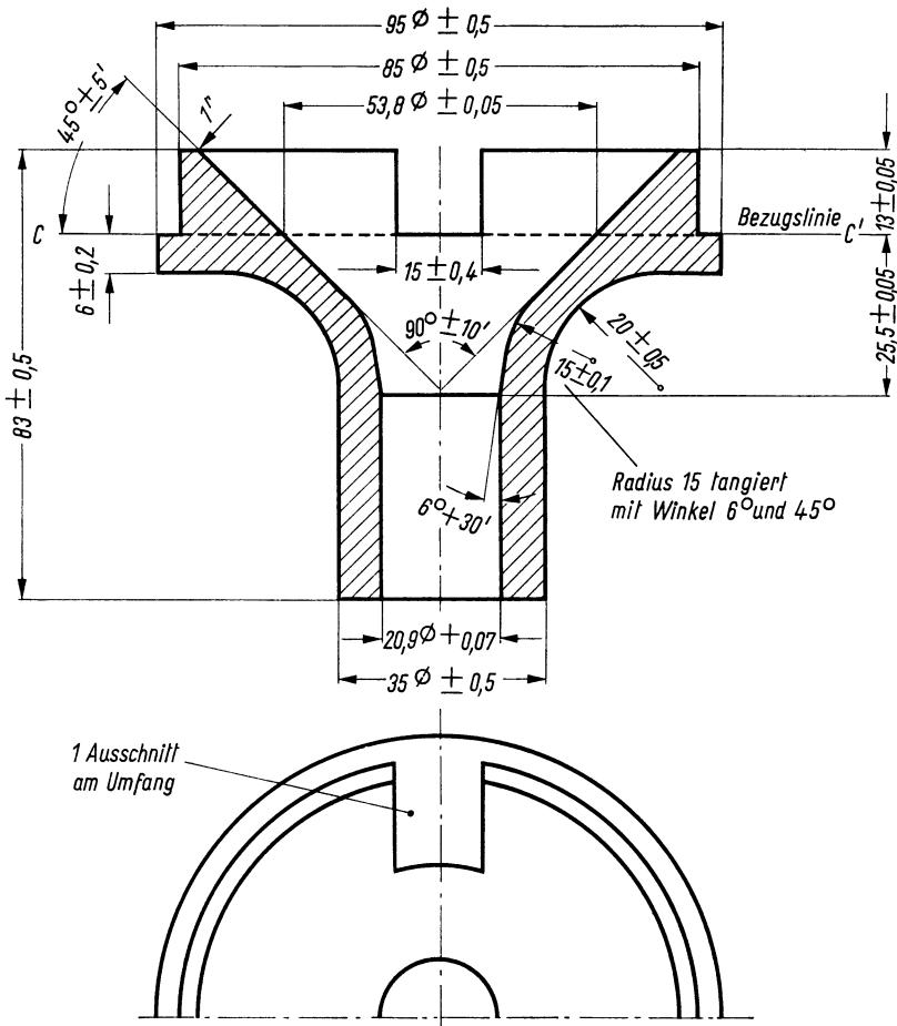
Die Bezugslinienlehre, die zur Bestimmung der Bezugslinie C-C' verwendet wird, gibt außerdem am Bildröhrenhals und Konusübergang die innere Mantelfläche der Ablenkspule an. Da die Konusform oberhalb der Bezugslinie verschieden sein kann, empfiehlt es sich, die Spule nicht mehr als  $13 \pm 0,05$  mm über die Bezugslinie hinausragen zu lassen.
