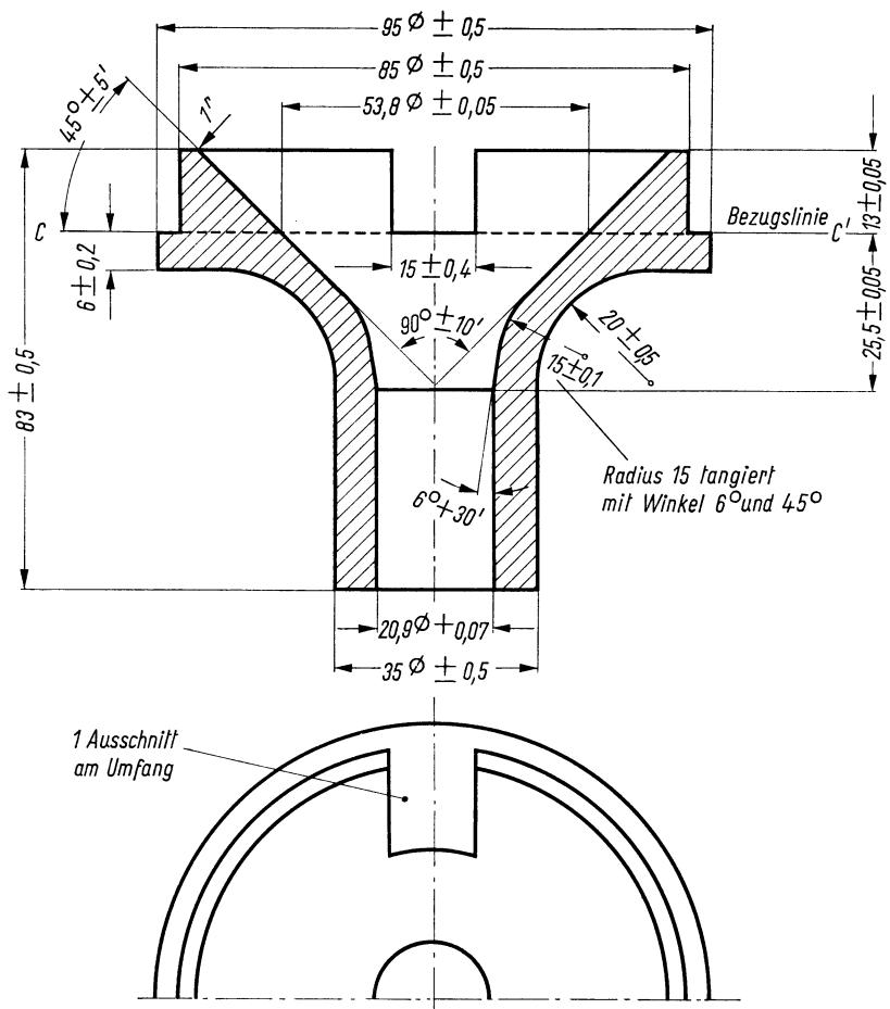
Die Bezugslienlehre, die zur Bestimmung der Bezugslien C-C' verwendet wird, gibt außerdem am Bildröhrenhals und Konusübergang die innere Mantelfläche der Ablenkspule an. Da die Konusform oberhalb der Bezugslien verschieden sein kann, empfiehlt es sich, die Spule nicht mehr als  $13 \pm 0,05$  mm über die Bezugslien hinausragen zu lassen.
