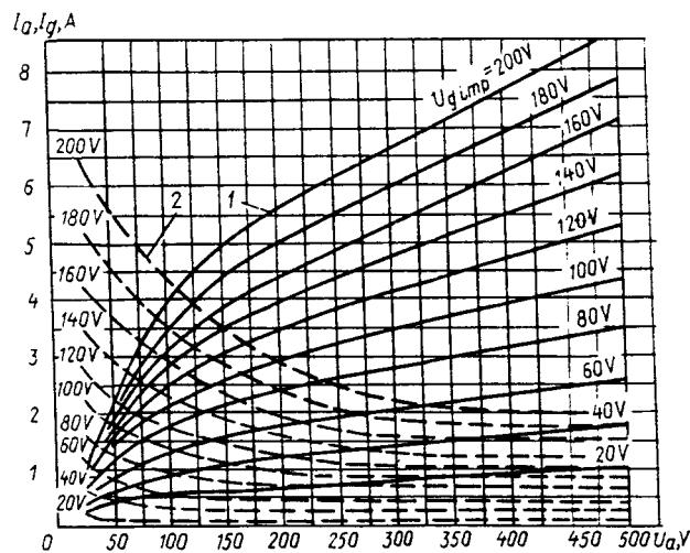
Усредненные импульсные характеристики (каждого триода):
