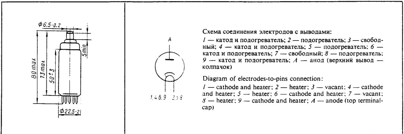
Схема соединения электродов с выводами:
