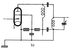
Die Röhre RES 094 ist außen metallisiert. Die Metallisierung ist an einen Kathodenstecker angeschlossen (vgl. Sockelschaltbild). Die Außenmetallisierung spart Abschirmmittel zwischen der Röhre und dem ihr zugeordneten Gitterkreis und bewirkt eine nicht unbeträchtliche Herabsetzung der Steuergitter-Anoden-Kapazität. Eine Abschirmung der einzelnen Abstimmkreise bzw. Stufen gegeneinander wird durch die Außenmetallisierung keinesfalls überflüssig gemacht.
