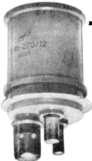
Предназначен для коммутации мощных импульсов в генераторах различных радиоэлектронных устройств. Позволяет уменьшить габариты генераторов, работающих в условиях больших вибрационных и ударных нагрузок. Оформление металлокерамическое.
