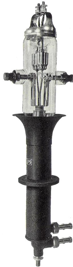
42 kW<sup>1)</sup> bei einem Wirkungsgrad von ca. 65% und einer Anodenspannung von 12 kV.
