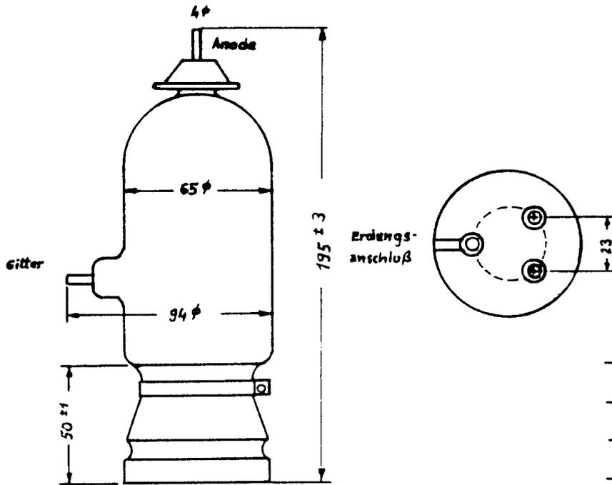
Heizspannung (auf  $\pm 3\%$  einst.)  $U_h = 10,5 \text{ V}$
