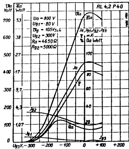
\*) Die tatsächliche Spannung am Schirmgitter beträgt 300 V verringert um den Spannungsabfall an  $R_{g2}$ .
