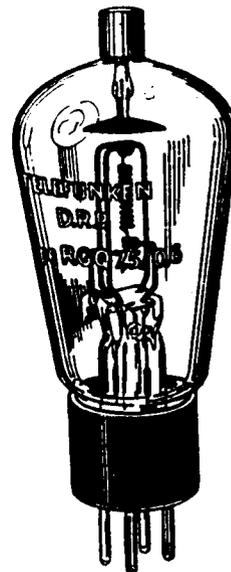
RGQ 7,5/0,6 ist ein Einweg-Gleichrichter mit Quecksilberdampf-Füllung. Er findet Anwendung in Gleichrichteranlagen zur Stromversorgung kleiner Sender und mittlerer Verstärkeranlagen.
