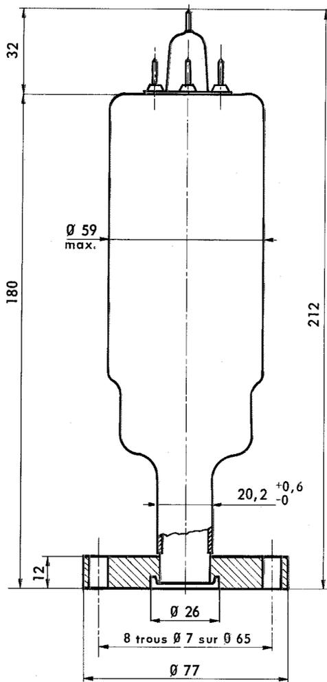
Jauge noyée constituée de la structure interne de la jauge F 9103 et d'une bride pour raccordement à une enceinte à vide équipée d'une bride de réception et d'un joint approprié.
