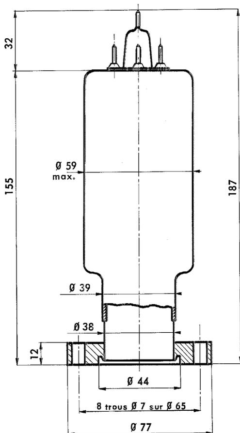
Variante de la jauge F 9103, avec manchon de 20,2 mm de diamètre, montée sur une bride, comme représenté sur le dessin ci-dessous, pour raccordement à une enceinte à vide équipée d'une bride de réception et d'un joint approprié.
