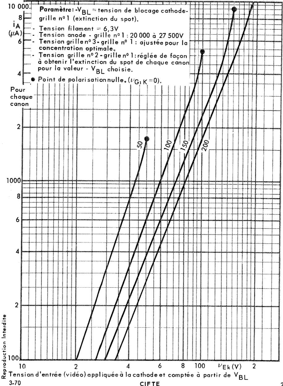
**Système de commande à tension de blocage fixe et signal vidéo d'amplitude réglable**
