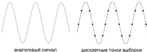
Частота дискретизации определяется временным интервалом между двумя соседними точками выборки. Максимальная частота дискретизации составляет 1 Гц (Гвыб/с).
