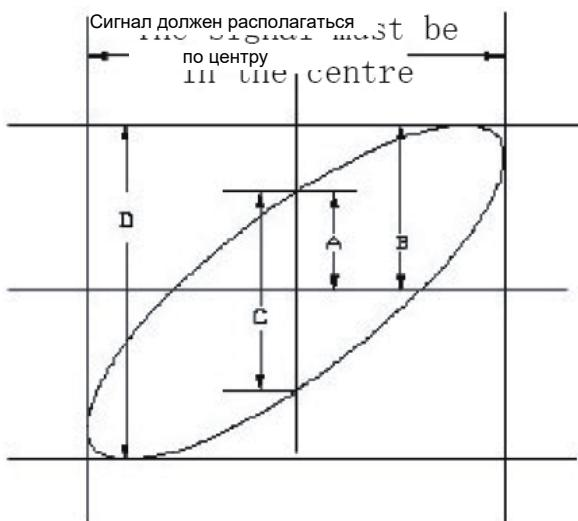
$\sin\theta = A/B$  или  $C/D$ , где  $\theta$  – разность фаз между сигналами с разных каналов. Определение величин А, В, С, Д дано на рисунке выше. Из приведенной выше формулы следует, что  $\theta = \pm \arcsin(A/B)$  или  $\theta = \pm \arcsin(C/D)$
