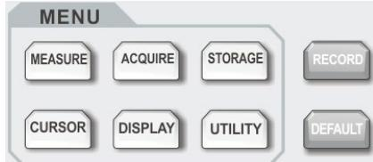
1. **[MEASURE]**: кнопка настройки измерений, позволяющая выбрать измерение всех параметров, заданных пользователем параметрами, выполнить статистический анализ измерений, выбрать индикаторы измерений и т.д.
