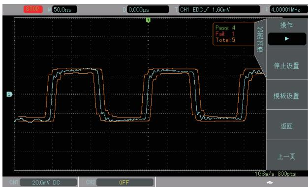
Допусковая проверка Pass/Fail
