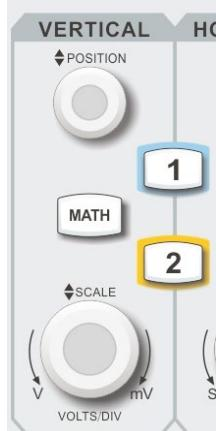
1. Нажмите кнопку **1**, чтобы включить или выключить отображение канала 1. Аналогичная кнопка с номером 2 управляет отображением канала 2.
