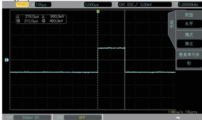
Измеренные значения отображаются в верхнем левом углу области отображения осцилограмм. Значение BX-AX – это результат измерения промежутка времени, а  $1/|BX-AX|$  – величина, обратная времени.
