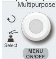
При операциях с меню поворотом регулятора можно выбрать нужное подменю, а затем нажатием на регулятор подтвердить выбор.
