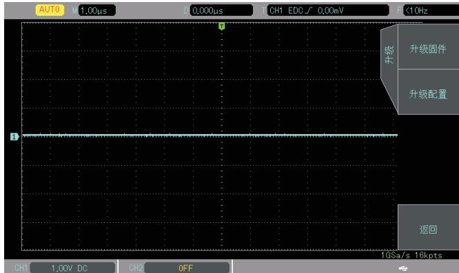
4. Процесс обновления может занять различное время в зависимости от содержания данного обновления. После выполнения процедуры обновления осциллограф автоматически перезагрузится для завершения обновления.
