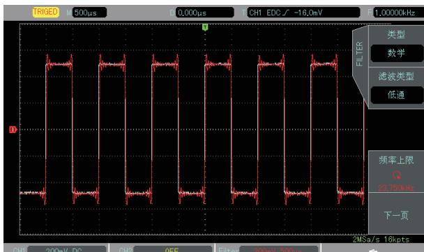
Применение цифрового фильтра к осциллограмме
