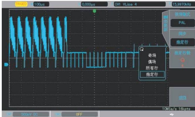
Запуск по синхроимпульсу строки видеосигнала
