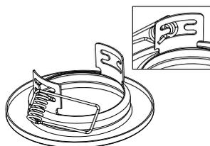
**1.** Вынуть фиксатор лапки из пружины. Завести в отверстие упор пружины, как показано на рисунке.
