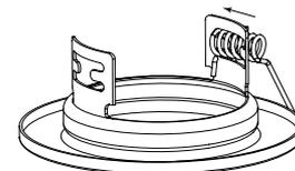
**2.** Надеть пружину на уши, сжав лапку пружины в направлении указанной стрелкой.
