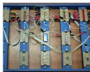
При диагностике, ремонте и пусконаладке электрических и электронных систем для временного подсоединения к существующей аппаратуре измерительных приборов, шунтов, временных обходных и тестовых соединений.
