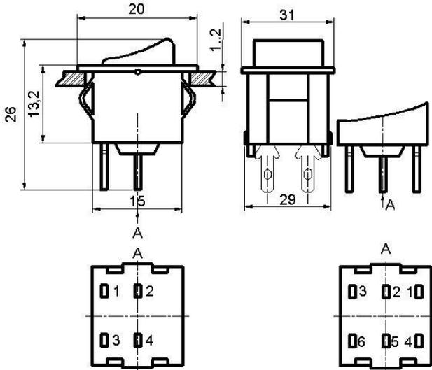
Тумблеры клавишные ручного управления предназначены для работы в электрических цепях переменного тока в радиоэлектронной аппаратуре. Изготавливаются в климатическом исполнении УХЛЗ и предназначены для объемного монтажа. Имеют 2 конструктивных исполнения, трех типонаименований каждое в зависимости от материала контактов.
