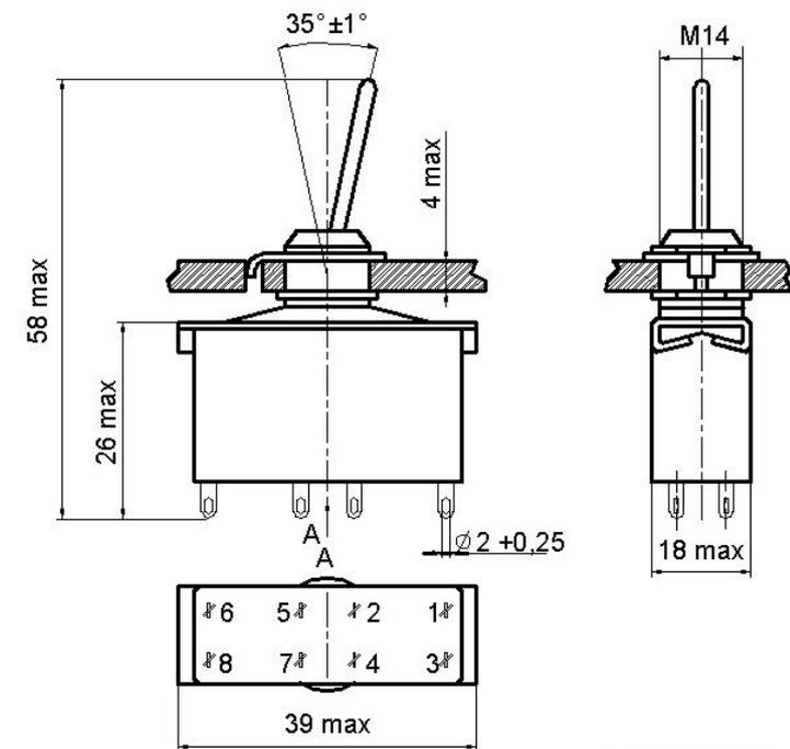
Тумблеры четырехполюсные предназначены для работы в электрических цепях постоянного и переменного тока в радиоэлектронной аппаратуре. Изготавливаются во всеклиматическом исполнении и для умеренного и холодного климата, являются изделиями ручного управления и предназначены для объемного монтажа. При необходимости комплектуются протектором.
