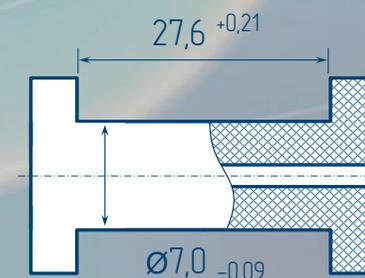
5000 витков, провод  $\varnothing$  0,08 мм
