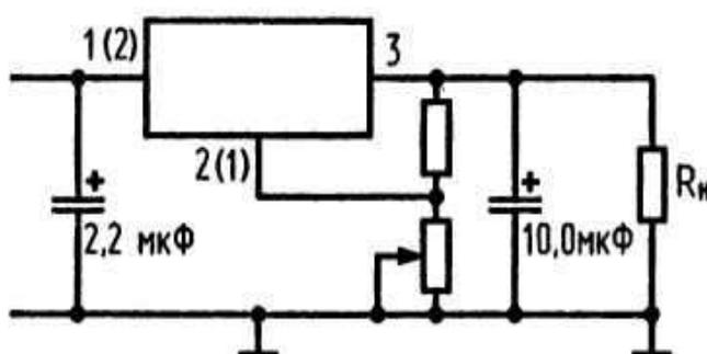
Схема включения КР1157ЕН9 (КР1157ЕН901)
