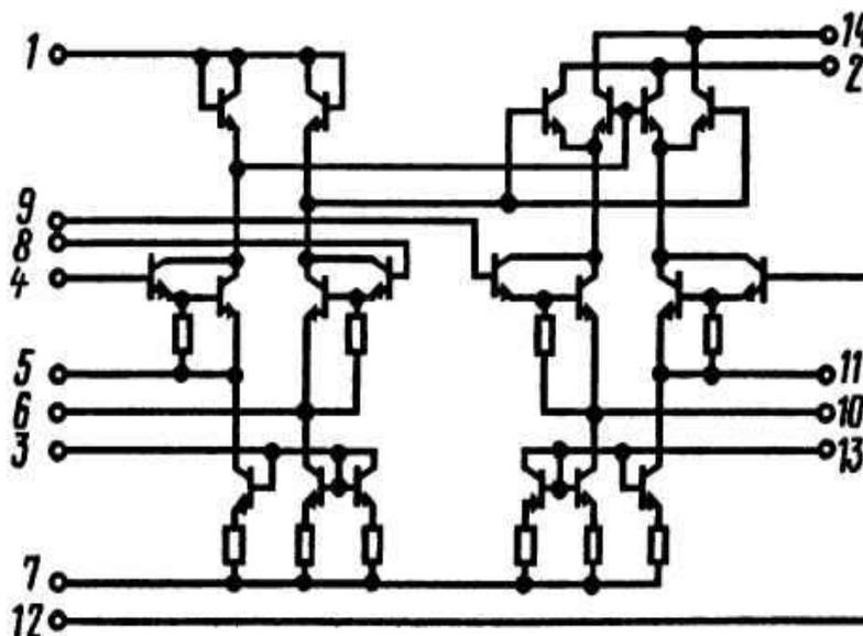
Электрическая схема К525ПС1, КР525ПС1
