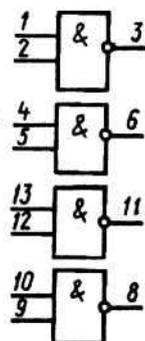
Назначение выводов: 1 - вход X1; 2 - вход X2; 3 - выход Y1; 4 - вход X3; 5 - вход X4; 6 - выход  $\overline{Y2}$ ; 7 - общий; 8 - выход  $\overline{Y4}$ ; 9 - вход X8; 10 - вход X7; 11 - выход  $\overline{Y3}$ ; 12 - вход X6; 13 - вход X5; 14 - напряжение питания.
