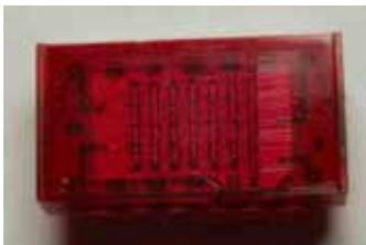
Арсенид-фосфид-галлиевые индикаторы знаковые красного цвета свечения в пластмассовом корпусе, предназначенные для визуальной индикации в аппаратуре.
