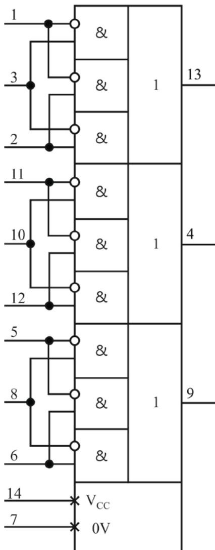
Т а б л и ц а 1. Назначение выводов микросхем 564ЛС1 ЭП.
