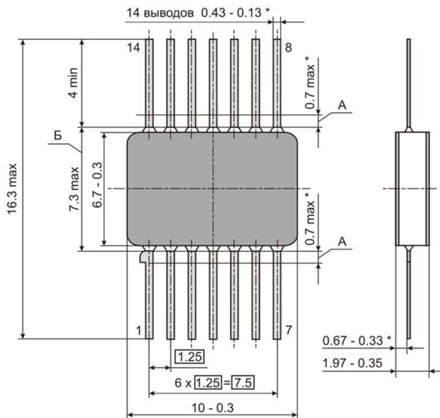
А - длина вывода, в пределах которой производится контроль смещения плоскостей симметрии выводов от номинального расположения.
