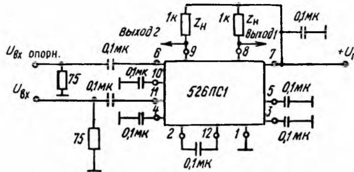
Типовая схема включения ИМС
