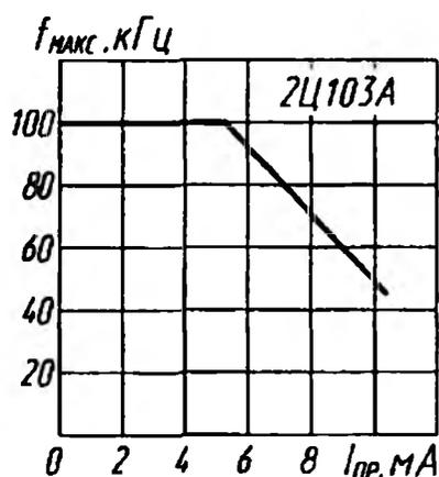
Зависимость предельной частоты преобразования от тока
