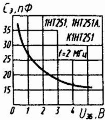
Зависимость емкости эмиттерного перехода от напряжения эмиттер—база
