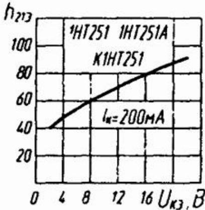
Зависимость статического коэффициента передачи тока от напряжения коллектор—эмиттер
