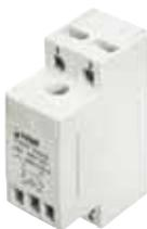
• Реле мощности общего применения • Катушки AC и DC • Высокая коммутируемая мощность: AC1 - 10 kVA; AC3 - 6 kVA • Монтаж на рейке 35 мм в соотв. с PN-EN 60715 • Высокое напряжение пробоя изоляции • Применение: управление электромагнитами; системы отопления, охлаждения, вентиляции, кондиционирования; управление однофазными двигателями; устройства и машины для гастрономии; системы автоматики; фотоэлектрические системы; прочее • Сертификаты, директивы: RoHS,
