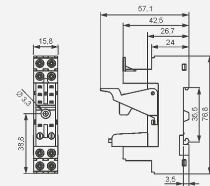
1 Монтаж и демонтаж аксессуаров в колодке; Модули сигнальные / защитные типа M... - смотри [www.repol.com.pl](http://www.repol.com.pl) 2 В скобках подана высота колодки с клипсой-вытаскивателем. 3 Для RM85..., RMP85: нагрузки выше 12 А (GZT80, GZM80, GZP80) или 10 А (GZS80, GZF80) требуют соединения зажимов: 11 с 21, 12 с 22, 14 с 24 - смотри [www.repol.com.pl](http://www.repol.com.pl)
