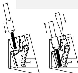
На рисунках представлено подключение провода в зажим Push-in и отключение провода посредством кнопки отпускания зажима (монтаж без использования инструмента).
