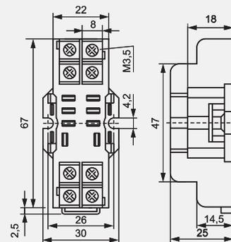
G4 1053 - для реле R2...WT, R4...WT; G4 1050 - для реле R2, R4 без WT
